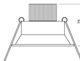
ORIGIN Deckeneinbauleuchte Ø98mm inkl. Netzgerät mit Steckverbindung, kardanisch
