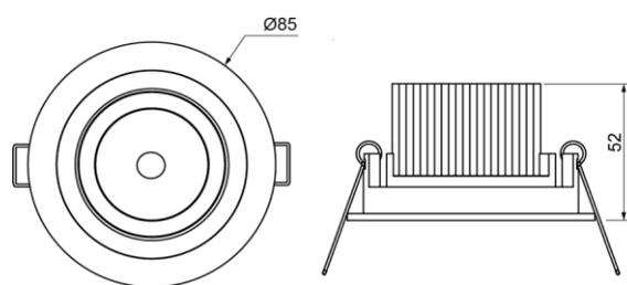
ORIGIN Deckeneinbauleuchte Ø85mm inkl. Netzgerät mit Steckverbindung, schwenkbar
