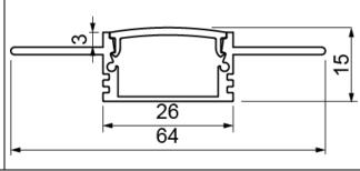
Aluminiumprofil inkl. opal satinierter PMMA-Profilabdeckung
