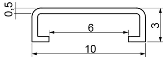
PMMA-Extrusionsprofil, weiß, zum Aufkleben mit doppelseitigen Klebestreifen
