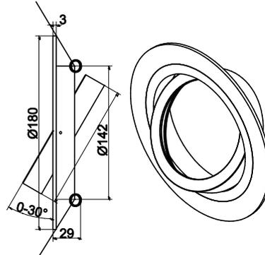
Deckeneinbauleuchte, schwenkbar, inkl. Zugentlastung
