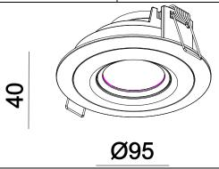
Deckeneinbauleuchte, schwenk-/drehbar, inkl. Zugentlastung und Fassung recessed ceiling downlight, adjustable, incl. strain-relief and socket
