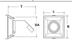
Druckguss-Einbauleuchte mit einer weißen Oberfläche, inklusive Zugentlastung und Modul zur Verbindung weiterer Einbauleuchten.
