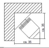
LED-Vitrinenspot, dreh-/ schwenkbar, Ø20mm, 1W/, 350mA
