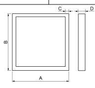
Deckenaufbaurahmen für LED-Panel EUROPE und LED-Panel GERMANY drei Seiten vormontiert, vierte Seite wird durch Magnetverschluss montiert.
